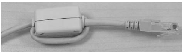
Bild 6-8. Ferritkern korrekt angebracht
